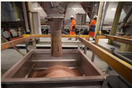
Des grenailles de cuivre sortent d'un broyeur de l'usine Recycâbles, située à Noyelles-Godault, le 19 mars 2025. FRANCOIS LO PRESTI / AFP
