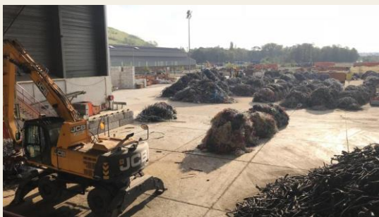
Des câbles électriques en fin de vie sont rassemblés pour recyclage (site RecyCâbles, partenariat Nexans-Suez).
